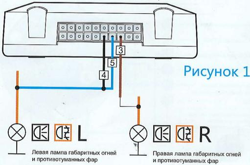
Схема подключения габаритных огней и стоп-сигналов (для односторонней лампы)
