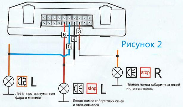
БЛОК СОГЛАСОВАНИЯ ЭЛЕКТРОПРОВОДКИ АВТОМОБИЛЯ С ПРИЦЕПОМ ОСУЩЕСТВЛЯЕТ ВСЕ ФУНКЦИИ КОНТРОЛЯ ОСВЕЩЕНИЯ ПРИЦЕПА, В ТОМ ЧИСЛЕ:
