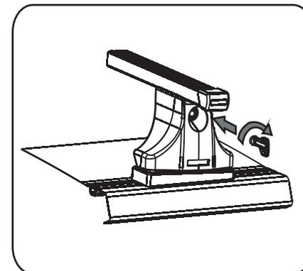
7. Потяните установленный багажник из стороны в сторону, чтобы убедиться, что он установлен надёжно. После установки груза на поперечины багажника, проверьте еще раз надежность и прочность его крепления и при необходимости подтяните винты. Периодически проверяйте состояние багажника и груза.
