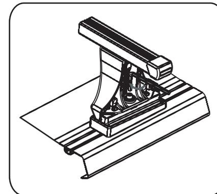
6. Установите крышку и закройте замок поворотом ключа по часовой стрелке.
