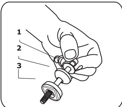
5. После того, как вы убедитесь, что отверстие в опоре расположено напротив точки крепления, вставьте винт в резьбовое отверстие крыши вашего автомобиля, затем затяните его Г-образным ключом. Последовательно затяните винты во всех 4-х опорах.
