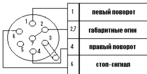
Рисунок 2. Схема подключения электрооборудования
