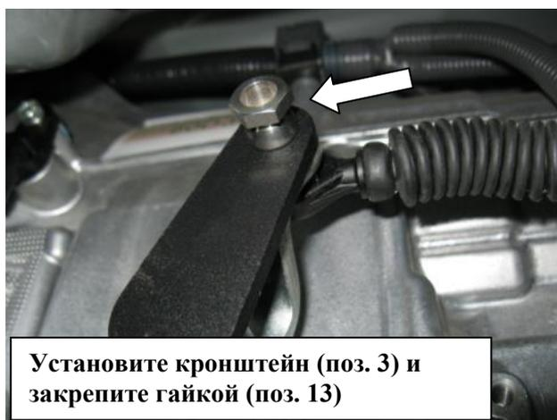
Установите кронштейн (поз. 3) и закрепите гайкой (поз. 13)
