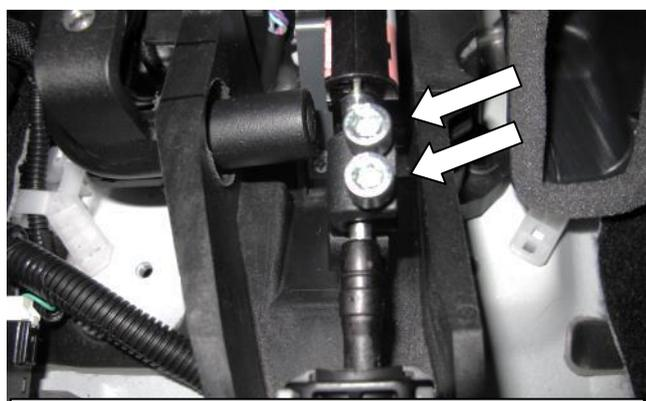
Установите хомут (поз. 6) закрепив болтами (поз. 8)
