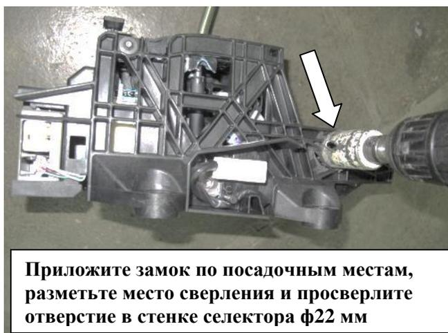
Приложите замок по посадочным местам, разметьте место сверления и просверлите отверстие в стенке селектора  $\varnothing 22$  мм
