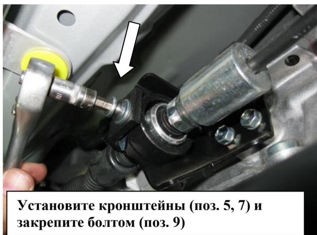
Установите кронштейны (поз. 5, 7) и закрепите болтом (поз. 9)
