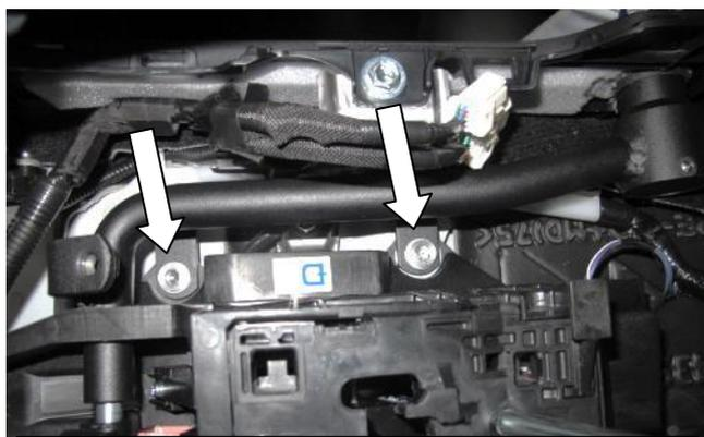
Установите замок (поз. 1) закрепив болтами (поз. 10, 11) с шайбами (поз. 14)
