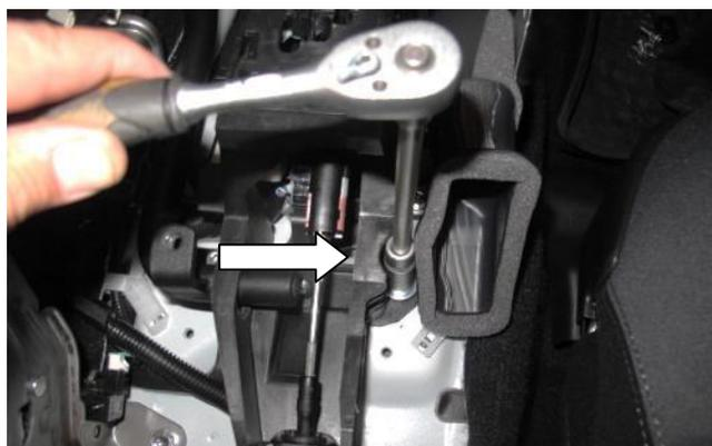
Открутите болт крепления селектора и установите шайбу (поз. 14)
