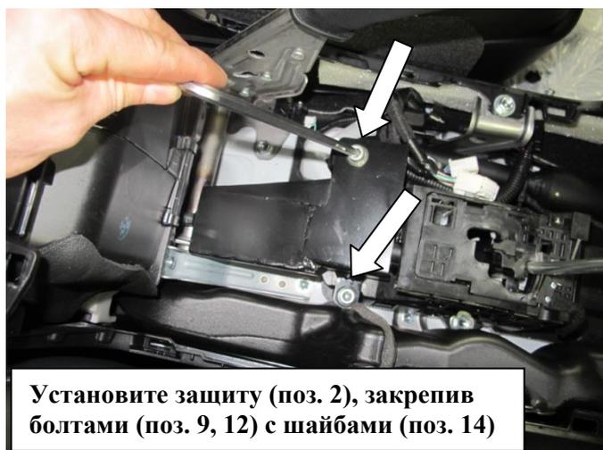
Установите защиту (поз. 2), закрепив болтами (поз. 9, 12) с шайбами (поз. 14)
