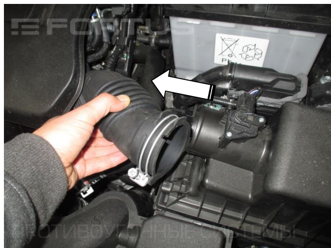
2. Отсоедините патрубок корпуса воздушного фильтра
