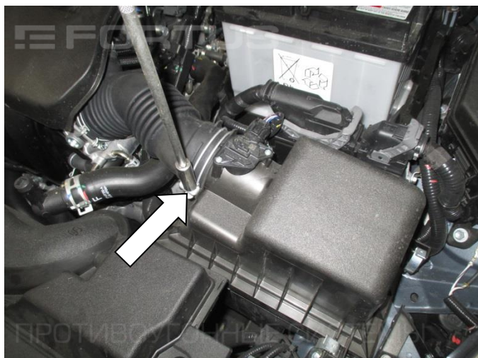
1. Открутите винт крепления патрубков воздушного фильтра
