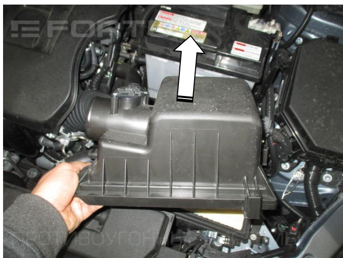
3. Снимите корпус воздушного фильтра
