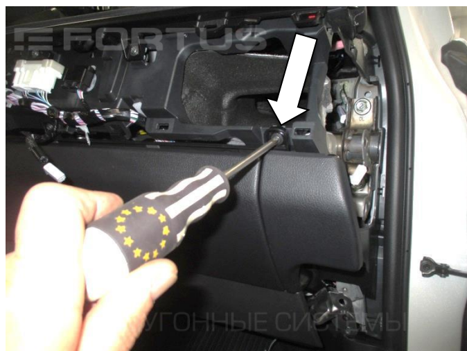
14. Открутите винт крепления консоли
