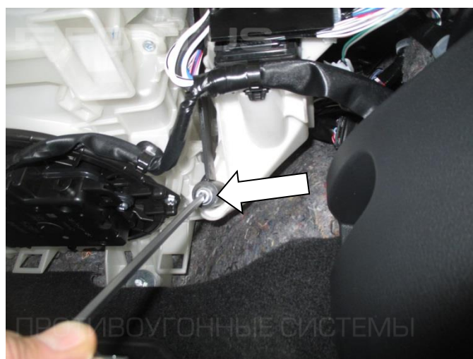
24. Закрепите кронштейн (поз. 1) с помощью болта (поз. 5) с шайбой (поз. 7)
