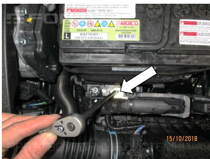
3. Открутите гайку крепления штатного кронштейна
