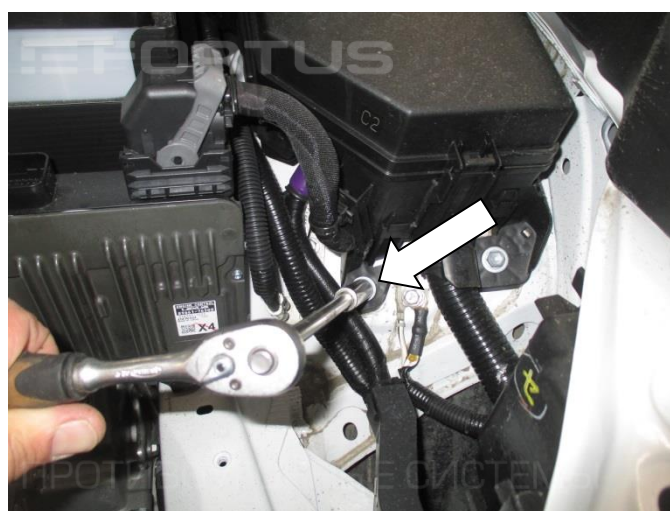
4. Открутите болт крепления штатного кронштейна
