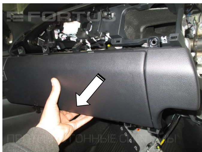
18. Снимите накладку консоли
