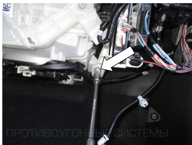
22. Открутите болт крепления кронштейна
