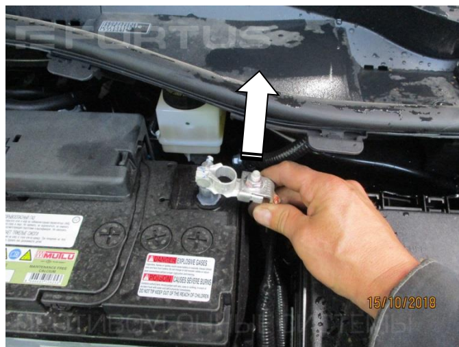
2. Снимите клемму аккумулятора
