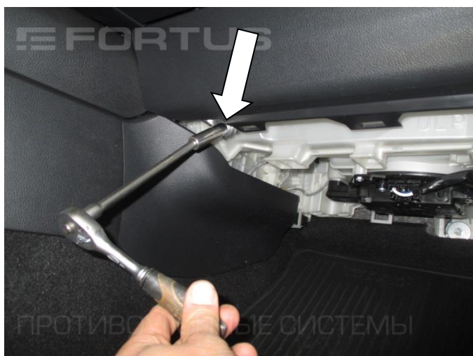
9. Открутите болт крепления консоли
