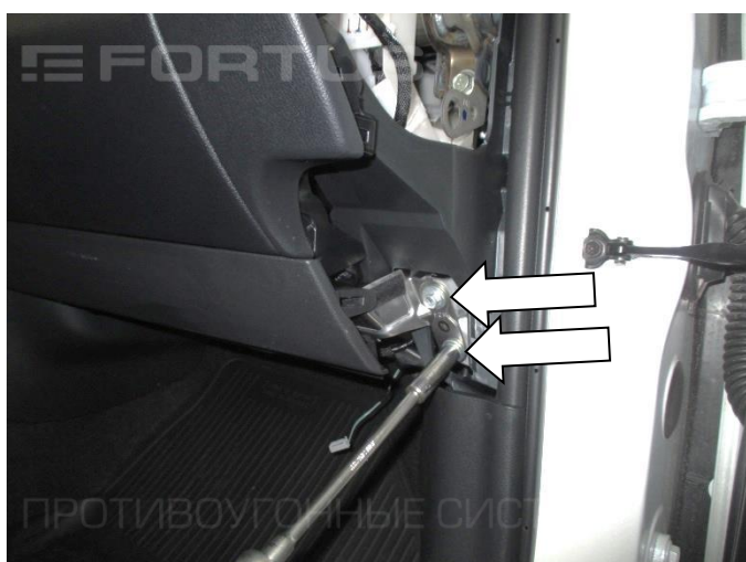
11. Открутите два болта крепления консоли
