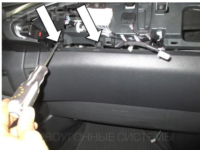
15. Открутите два винта крепления консоли
