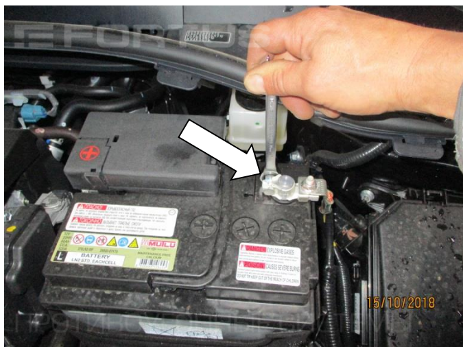
1. Открутите гайку крепления плюсовой клеммы аккумулятора.
