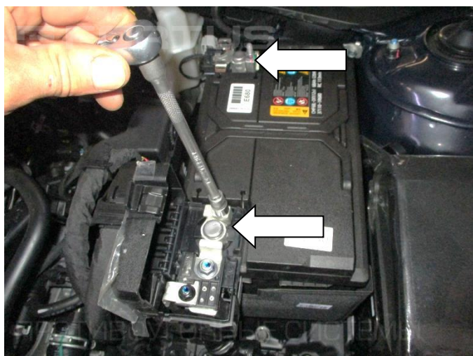
1. Открутите гайки крепления клемм аккумулятора. Снимите клеммы
