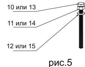
**д.** Соберите крепежный болт как показано на рис.(5). Для чего возьмите болты [10] или [13] и на винтике гайки [11] или [14] до шляпки болта. Оденьте шайбы [12] или [15] на болты.
