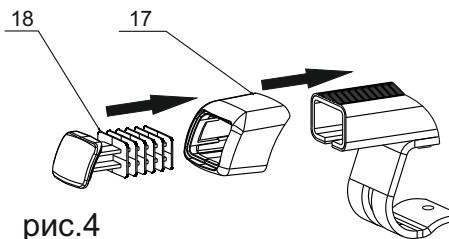
**с.** Вставьте заглушку состоящую из двух частей [17] и[18] в поперечину, как показано на (рис.4)
