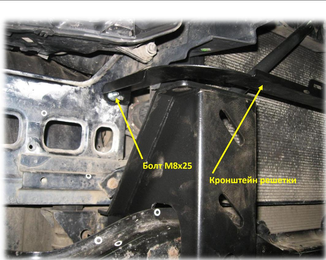
7. Установить кронштейн решетки. Крепление кронштейна - к кузову двумя болтами M8x25 (с двумя шайбами и гайкой), по одному с каждой стороны.
