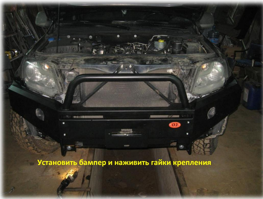
8. Установить бампер и наживить гайки крепления к кронштейнам.
