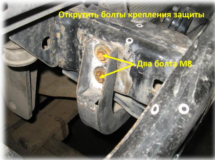
3. Открутить по два болта М8 крепления штатной защиты двигателя справа и слева.
