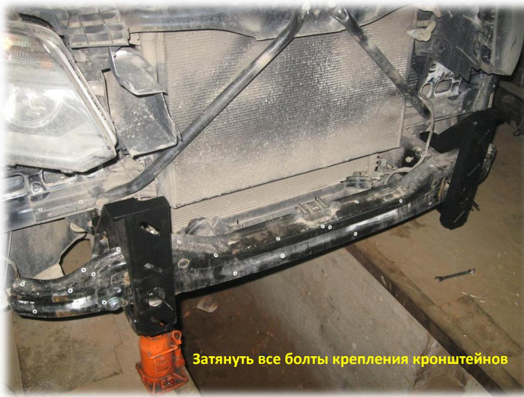
После установки кронштейнов и всех болтов крепления - болты затянуть. Затяжку рекомендуется начинать с болтов M8. Болт M12x40 с самоконтрящейся гайкой затягивать последним.
