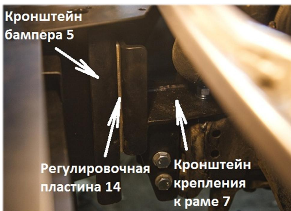
7. Совместить кронштейны бампера с кронштейнами крепления к раме. Закрепить с помощью прилагаемого крепежа.
