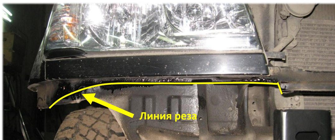
Итоговый вид кузова, подготовленного к установке бампера.
