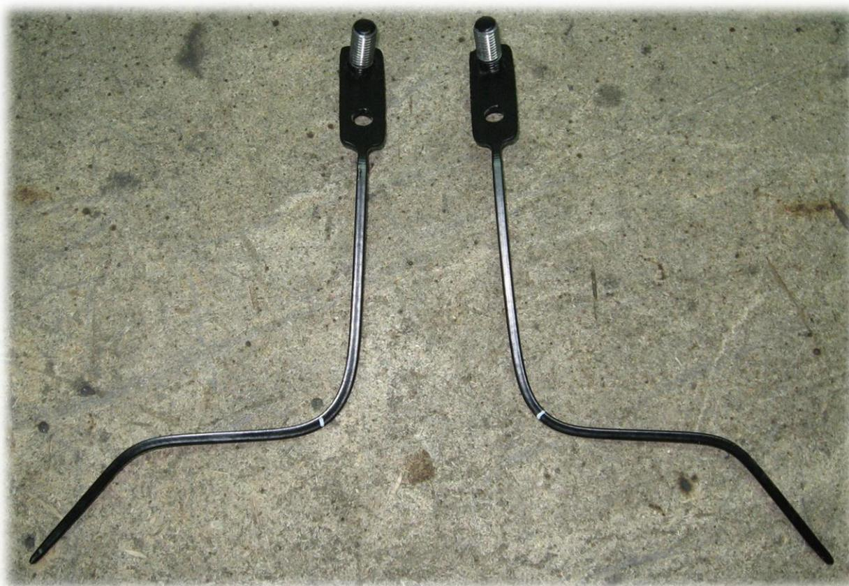
Перед установкой закладных рекомендуется убедиться, что гайки легко наворачиваются на резьбу болтов. При необходимости резьбу болтов "прогнать" плашкой M12x1,75.
