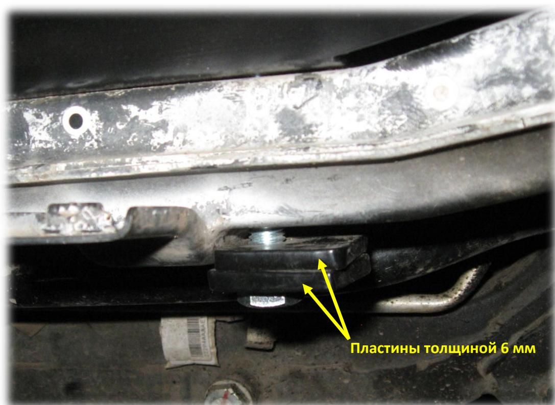
7. Установить закладные с болтами M12 в лонжероны рамы. Закладные вставляются через отверстия на внутренней стенке лонжеронов за поперечиной.
