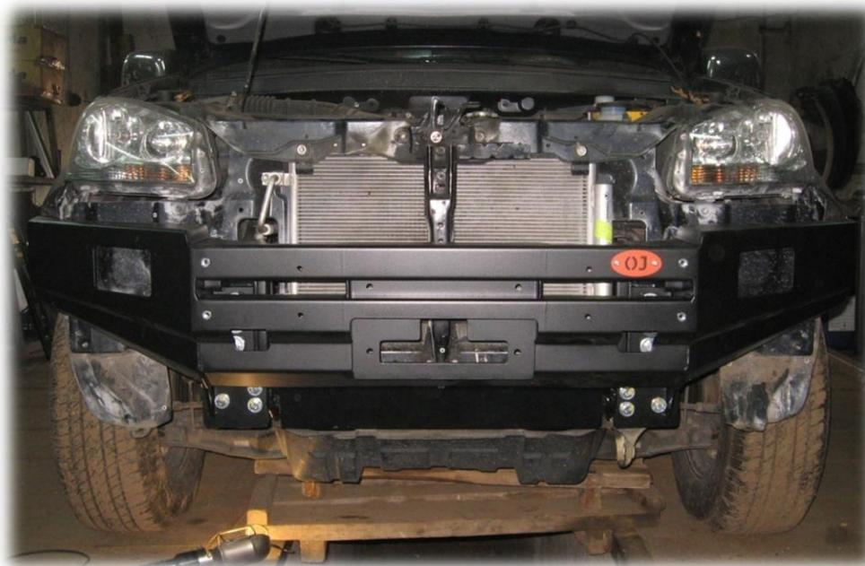
Бампер крепить болтами M12x40 и самоконтрящимися гайками M12. Обязательно использовать увеличенные шайбы из комплекта бампера.
