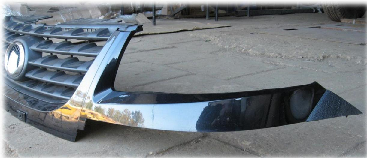
12. Установить штатный пластиковый бампер. В центральной части бампер закрепить к кузову с помощью держателя из комплекта. Держатель крепится к бамперу штатным саморезом крепления решетки, к кузову болтом М8х25 из комплекта.
