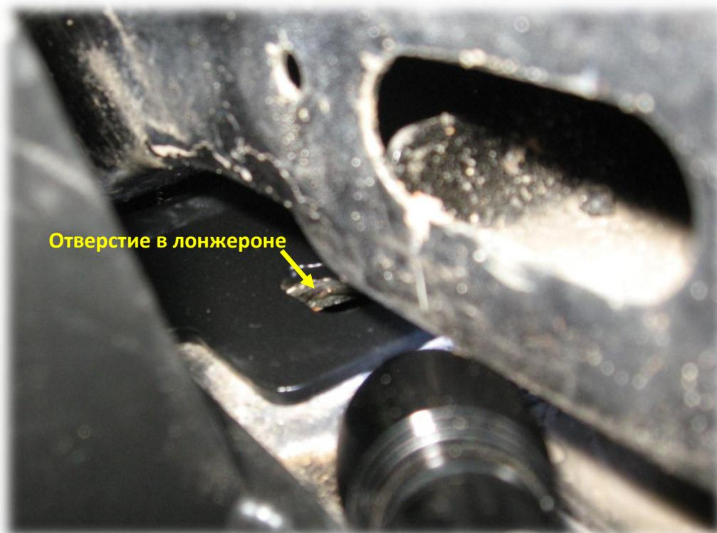
На болт установить увеличенную шайбу и наживить гайку.
