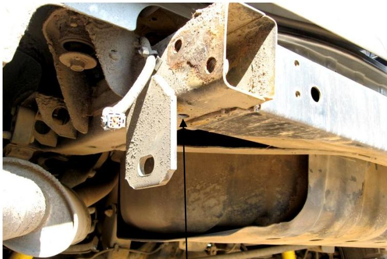
Рис 7. Отверстие для закладной.
