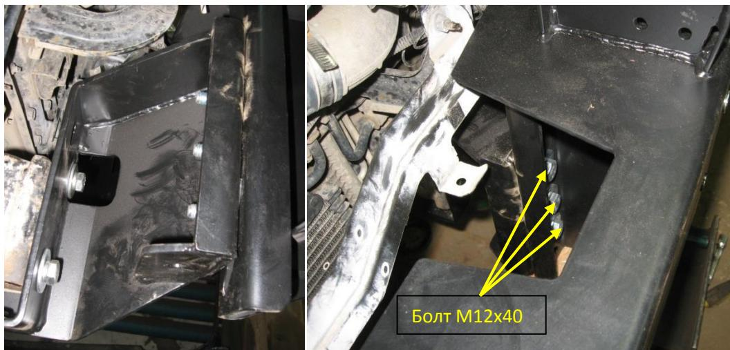
4. Бампер устанавливается с зазором 10...15 мм. относительно фар и кузова автомобиля.
