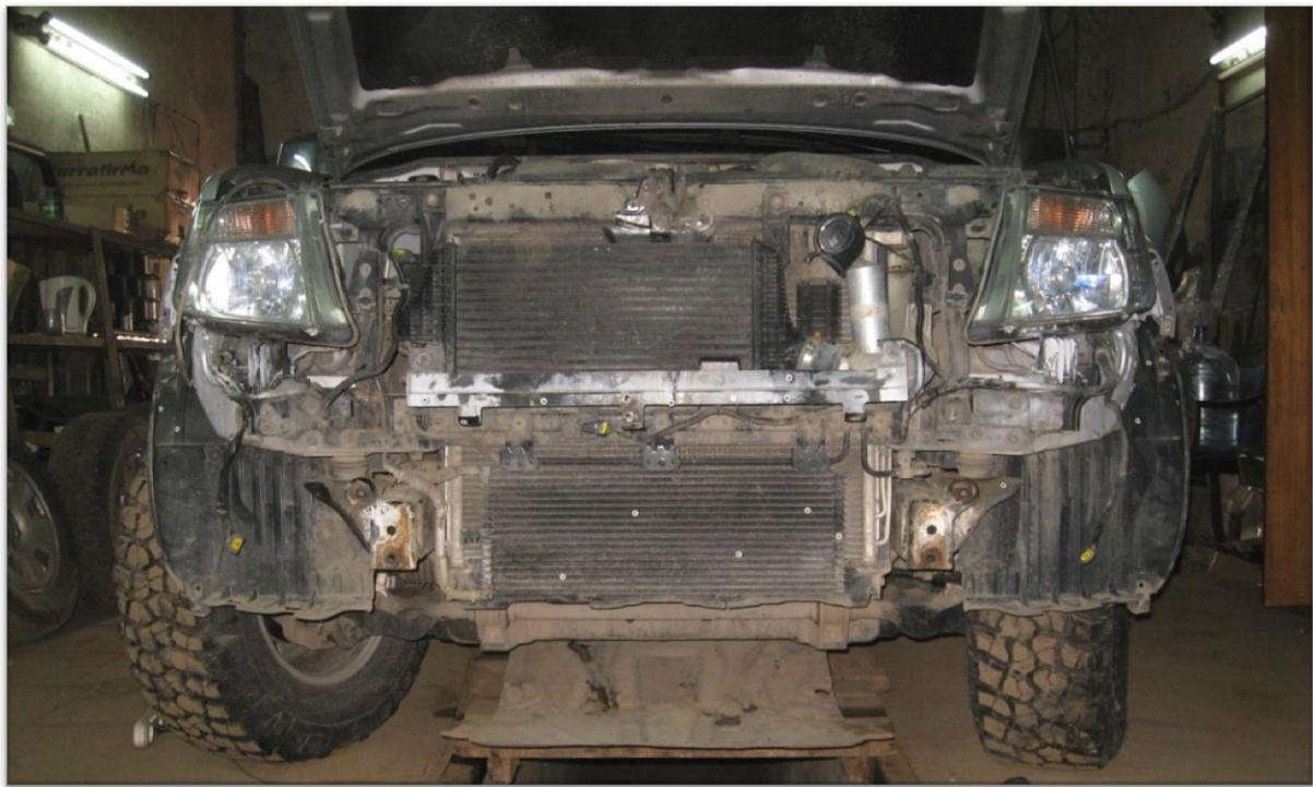
2. Установить кронштейны бампера совместно с кронштейнами панели защиты и закрепить болтами M12x1,25x35 (4 шт. на каждый кронштейн).
