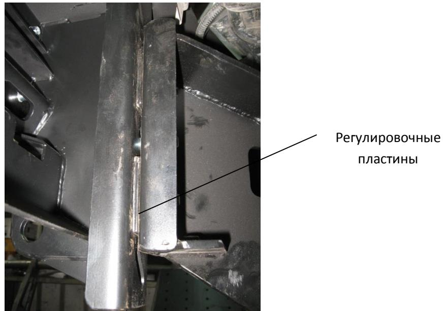
5. Добейтесь симметричного расположения бампера относительно кузова. Крайние точки бампера могут выступать за габарит крыла на 5-10 мм.
