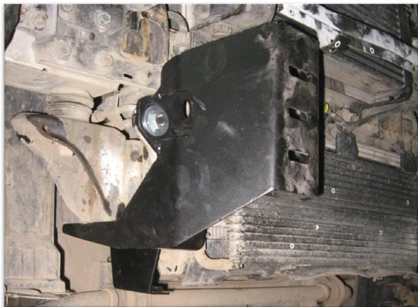
3. Установить бампер на автомобиль, наживить болты крепления бампера к кронштейнам(M12x40) выровнять его по горизонтали и вертикали.
