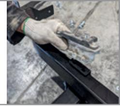
**ШАГ 3.** Установите закладные пластины с двумя гайками в технологические отверстия лонжерона с правой и левой стороны автомобиля. Установите левый и правый кронштейны на место демонтированной штатной балки. На нижние шпильки с обеих сторон установите кронштейны бампера, наживите с обеих сторон кронштейн ТСУ и кронштейн бампера штатными демонтированными гайками. Наживите кронштейны и закладные пластины болтами M12, шайбами 12 гроверными и шайбами 12.
