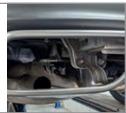
**ШАГ 2.** Отсоедините разъём с датчика, установленного на балке. Открутите по 4 гайки крепления штатной балки с правой и левой стороны, после чего демонтируйте ее. Снимите датчик со штатной балки автомобиля и прикрутите к балке ТСУ, используя гайки М6 нейлон.
