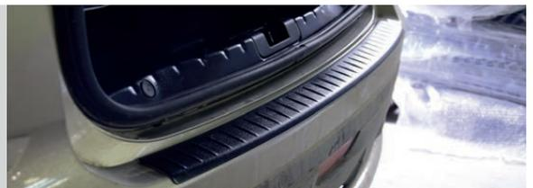
**ВНИМАНИЕ!** При ежедневной эксплуатации автомобиля (особенно в демисезонное время), на пластиковых деталях возможно появление белёсого налёта. Для предотвращения этого, после каждой мойки автомобиля рекомендуется применять средства для ухода за наружным черным пластиком, либо полироль для пластика с эффектом чернения.
