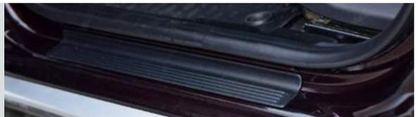
**ВНИМАНИЕ!** При ежедневной эксплуатации автомобиля (особенно в демисезонное время), на пластиковых деталях возможно появление белёсого налёта. Для предотвращения этого, после каждой мойки автомобиля рекомендуется применять средства для ухода за наружным черным пластиком, либо полироль для пластика с эффектом чернения.
