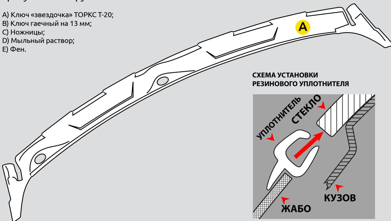
Перед началом эксплуатации накладки необходимо убедиться, что накладка не задевает кромку капота, для этого закройте полностью капот. Убедитесь в присутствии равномерного зазора не менее 4-5 мм вдоль всей кромки капота, в противном случае отрегулируйте крепление крышки капота добившись необходимого зазора!
