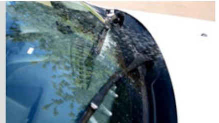
Перед началом эксплуатации наклейки необходимо убедиться, что наклейка не задевает кромку капота, для этого закройте полностью капот. Убедитесь в присутствии равномерного зазора не менее 4-5 мм вдоль всей кромки капота, в противном случае отрегулируйте крепление крышки капота добившись необходимого зазора!
