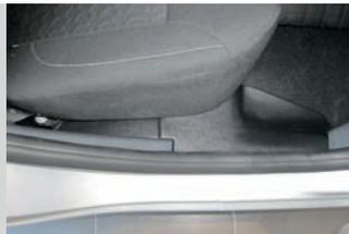
**ВНИМАНИЕ!** При ежедневной эксплуатации автомобиля (особенно в демисезонное время), на пластиковых деталях возможно появление белёсого налёта. Для предотвращения этого, после каждой мойки автомобиля рекомендуется применять средства для ухода за наружным черным пластиком, либо полироль для пластика с эффектом чернения.
