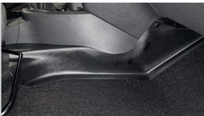
**ВНИМАНИЕ!** При ежедневной эксплуатации автомобиля (особенно в демисезонное время), на пластиковых деталях возможно появление белёсого налёта. Для предотвращения этого, после каждой мойки автомобиля рекомендуется применять средства для ухода за наружным черным пластиком, либо полироль для пластика с эффектом чернения.
