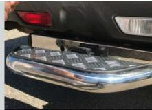
ШАГ 2. Установите палец для фаркопа и зафиксируйте его шплинтом пружинным.
