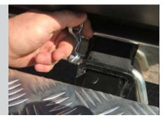
ШАГ 3. Зафиксируйте кронштейн фаркопа болтом М10х20 снизу.
