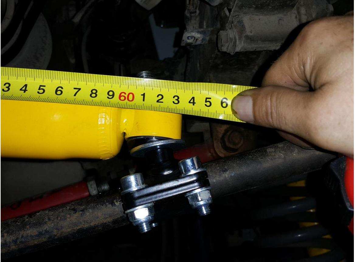
4. Демпфер должен располагаться непосредственно над рулевой тягой, вдоль неё. Кожух демпфера должен быть расположен на кронштейне рамы.
