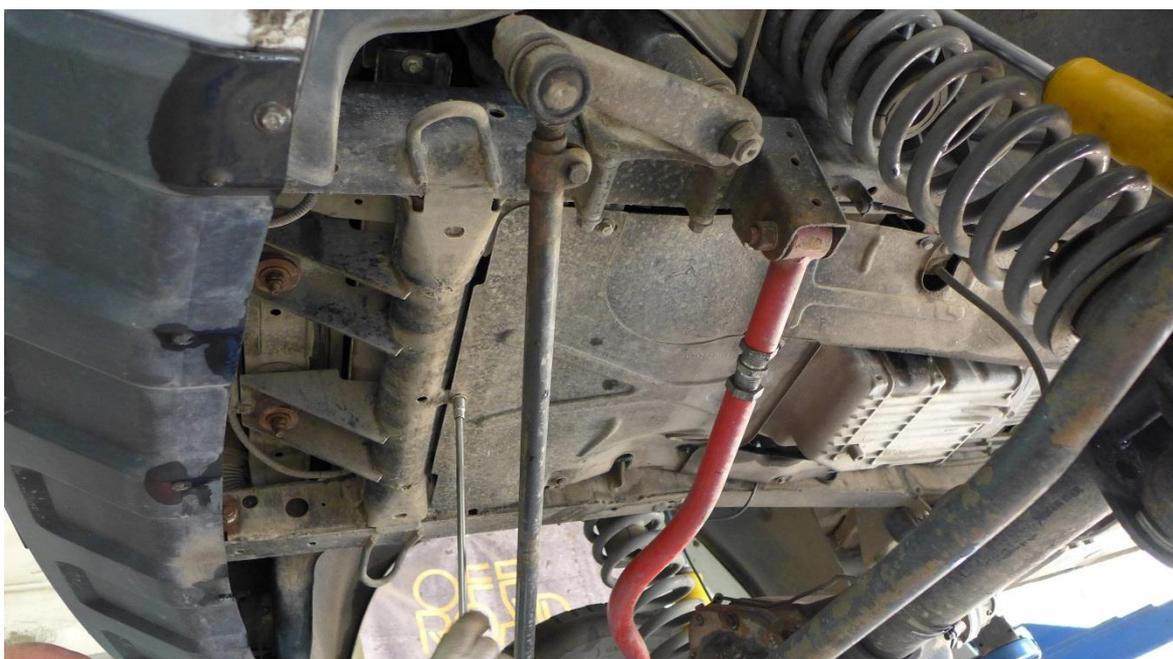
В некоторых случаях удаётся установить струбцину без доработки защиты. Установить кронштейн-уголок на правую сторону рамы автомобиля с помощью струбцины. Ухо должно располагаться снаружи рамы автомобиля и быть развёрнуто вниз. Гайки струбцины затягивать после окончательной установки.
