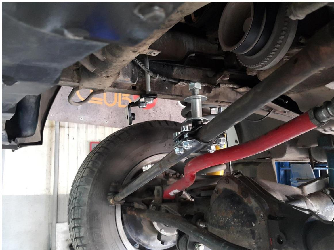
2. На длинную рулевую тягу установить кронштейн-палец. Ось на кронштейне имеет наклон по отношению к оси рулевой тяги. Палец должен располагаться вертикально вверх и иметь наклон к левому колесу автомобиля. Расстояние между осями кронштейнов 610-620 мм. Болты кронштейна затягивать после окончательной установки.
