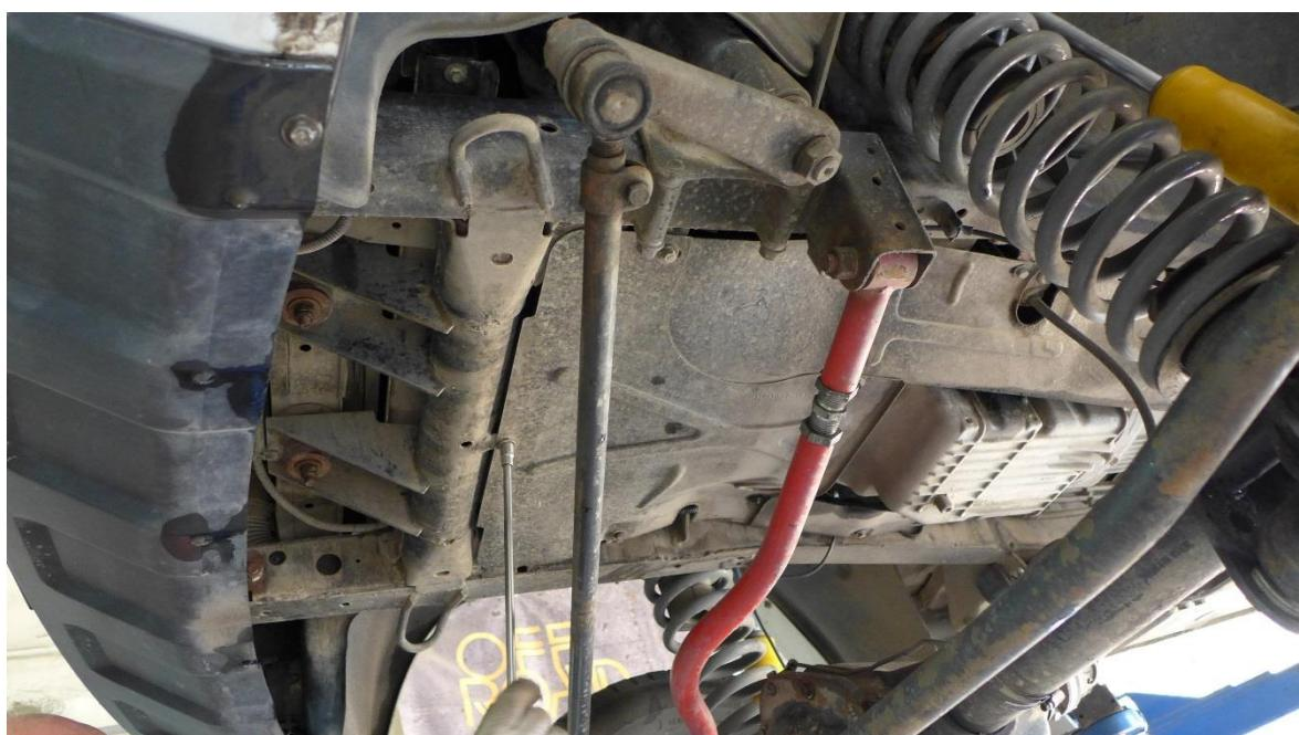
В некоторых случаях удаётся установить струбцину без доработки защиты. Установить кронштейн-уголок на правую сторону рамы автомобиля с помощью струбцины. Ухо должно располагаться снаружи рамы автомобиля и быть развернуто вниз. Гайки струбцины затягивать после окончательной установки.
