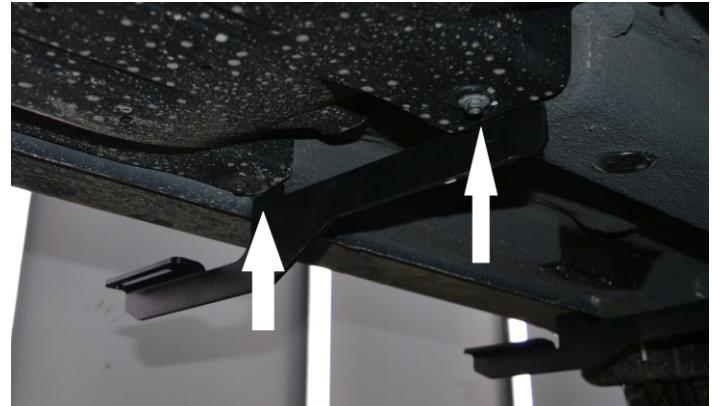
Рис. 4 - Установка среднего кронштейна
