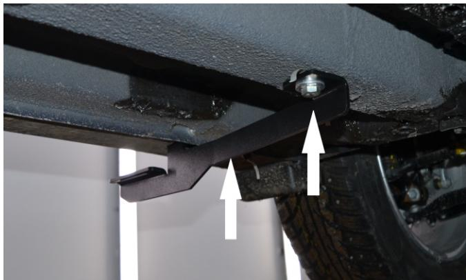
Рис. 3 - Установка переднего кронштейна
