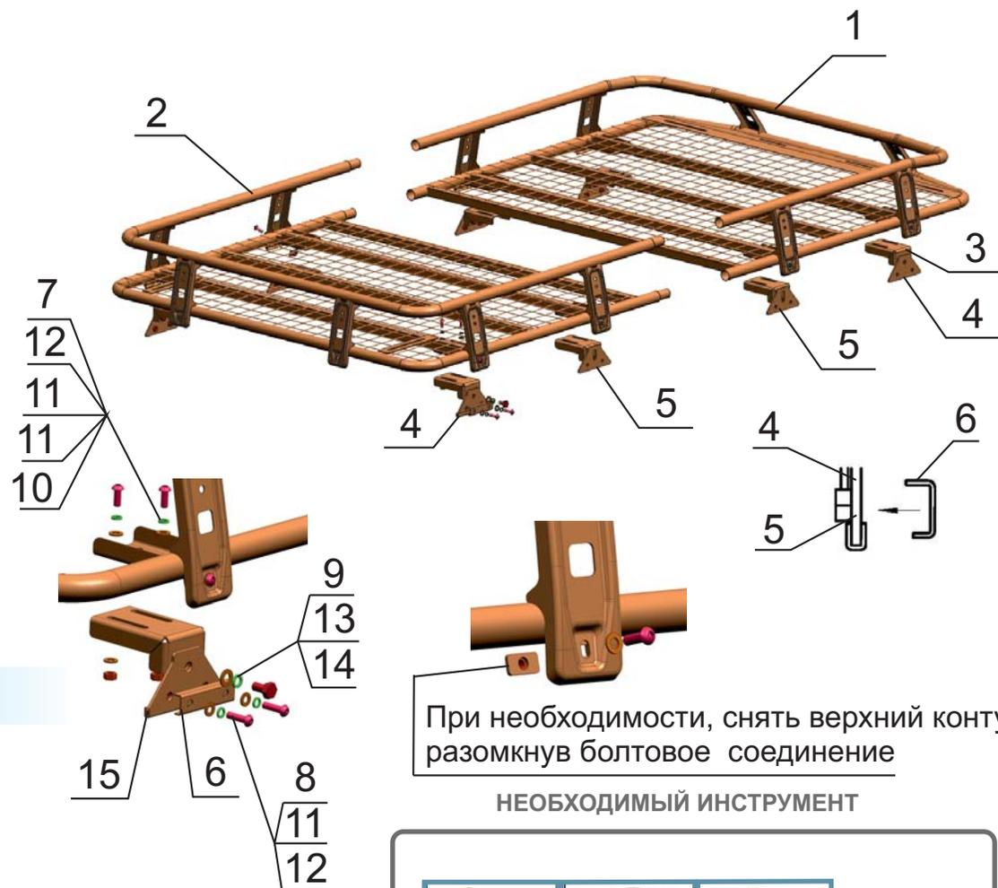
При необходимости, снять верхний контур, разомкнув болтовое соединение
