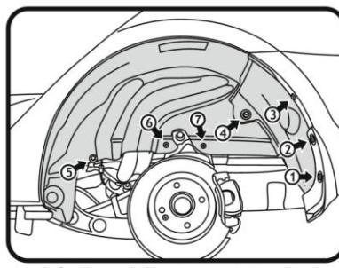
Задний левый. Монтаж крепления. Рис.2
