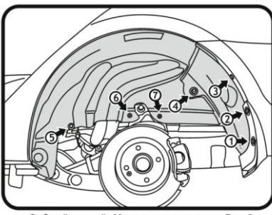
Задний левый. Монтаж крепления. Рис.2
