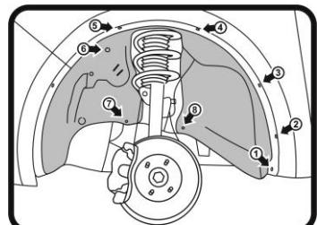
Передний левый. Монтаж крепления. Рис. 2
