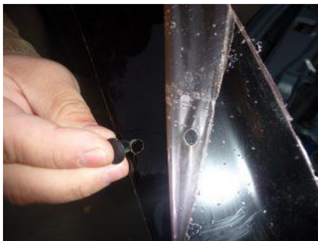
4. Вставить в кнопку крепежный крючок
