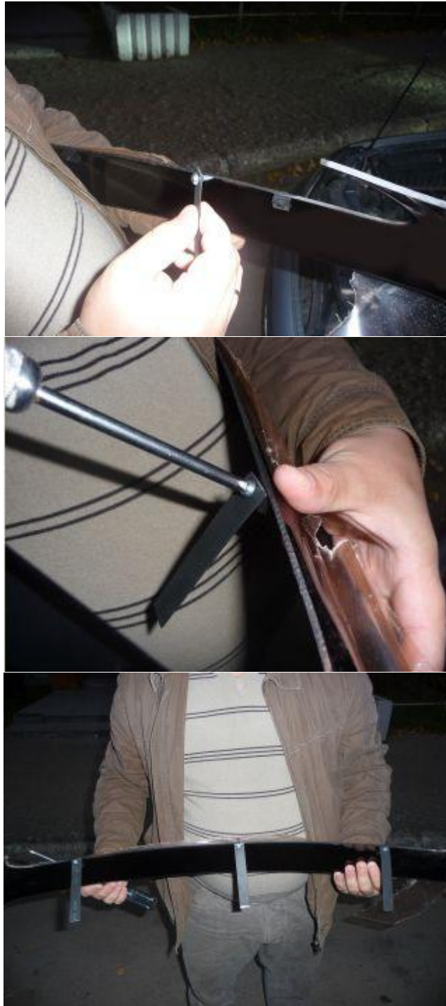
6. Загните пластины под капот
