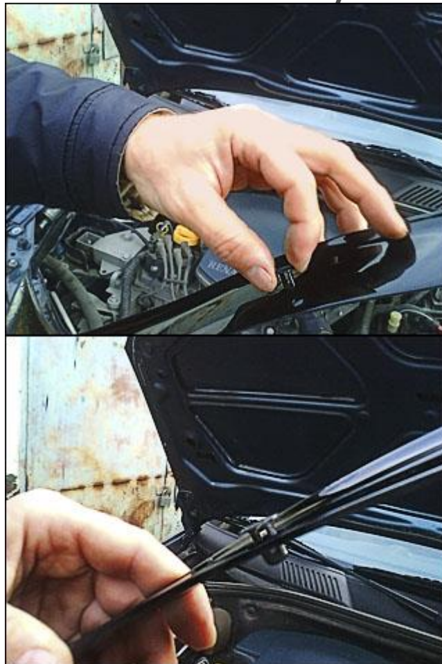
5. Вставить кнопку в крепежный крючок
