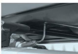
2 Вставьте скобы крепления снизу через поперечины в технологические отверстия днища автобокса.
