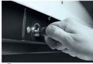
8 Для закрытия автобокса плотно закройте крышку, убедитесь что петли замков заведены в посадочные места механизма запирания, поверните ключ по часовой стрелке.
