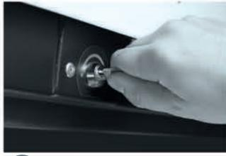
7 Для открытия автобокса вставьте ключ в личинку замка и поверните против часовой стрелки (при открытом автобоксе ключ остаётся в замке).
