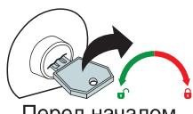
Перед началом движения проверьте закрытие замка
