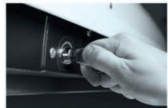
8 Для закрытия автобокса плотно закройте крышку, убедитесь что петли замков заведены в посадочные места механизма запираения, поверните ключ по часовой стрелке.
